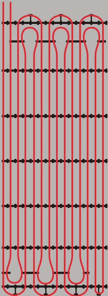
**AquaSurface** – это система лучистого отопления / охлаждения. Она состоит из труб, собранных в готовый модуль. Система пригодна для стенового, потолочного и напольного монтажа. Активная поверхность обладает низкой инерционностью.
